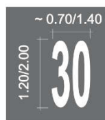
Abbildung 2: Form und Abmessungen Markierung «20» bzw. «30», SN 640 851
