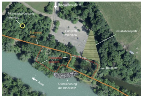
Übersicht Ufersicherung Wehrlau. Seit Mittwoch, 20. Januar 2016 wird das Ufer auf einer Länge von knapp 50 Metern mit Blocksteinen gesichert. Die Baustellenzufahrt führt via Pöschelstrasse und unterer Uferweg zum Parkplatz Wehrlau. Für den Installationsplatz werden zehn Parkplätze gesperrt.
