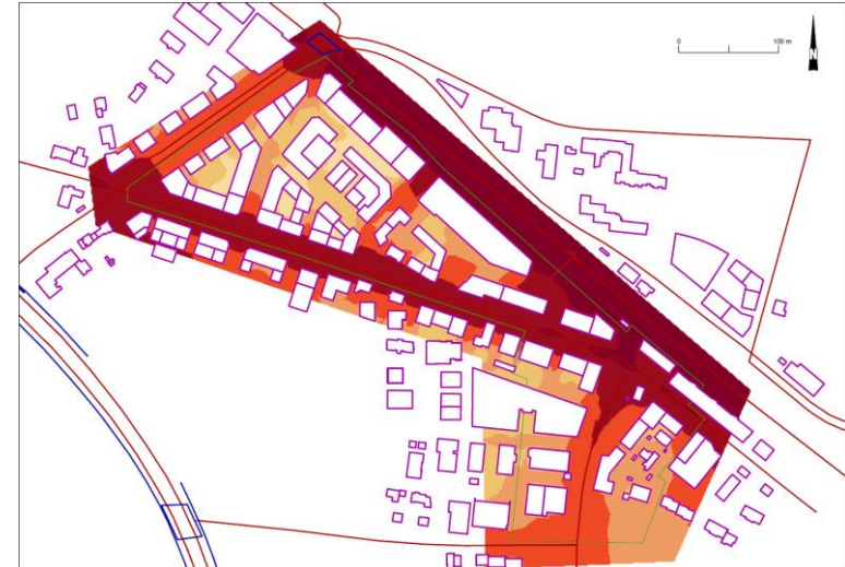
Abbildung 18: vdw , Höhe 10 m ab Boden, Lärmimmissionen Tag
