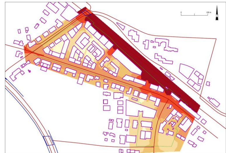
Abbildung 20: vdw , Höhe 10 m ab Boden, Lärmimmissionen Nacht
