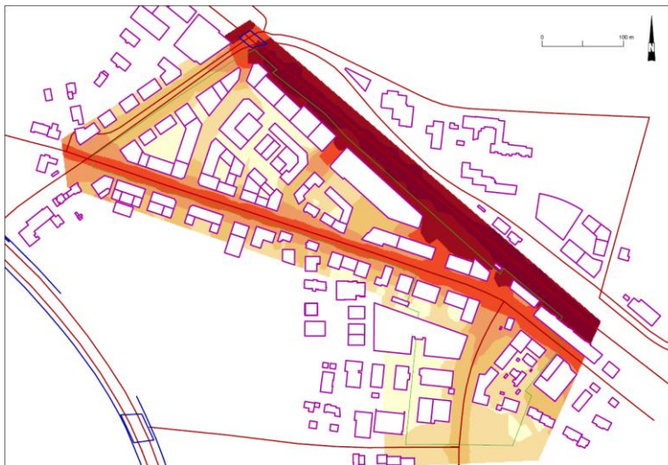
Abbildung 19: vdw , Höhe 4.5 m ab Boden, Lärmimmissionen Nacht
