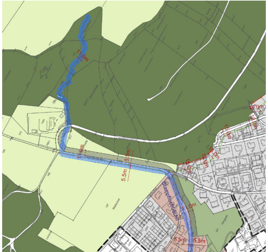
Abbildung 56: Gewässerraum und Freihaltegebiet (Gewässerentwicklungsraum) Stampflochbach, Abschnitt Nord
