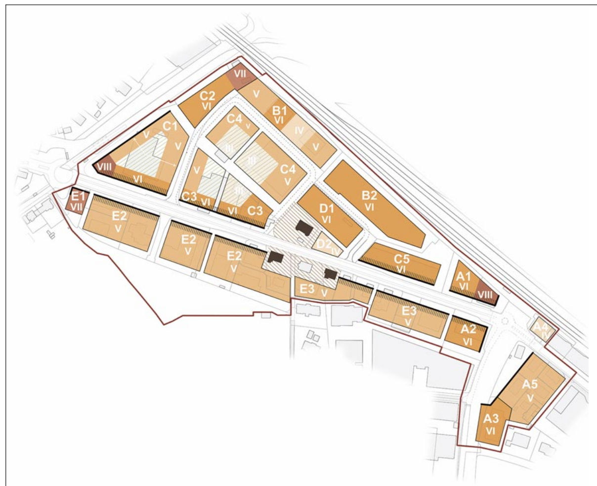
Die Baufelder im Perimeter des Masterplans 2022: Jedem Baufeld ist eine maximale Geschosshöhe zugeordnet (römische Ziffern)
